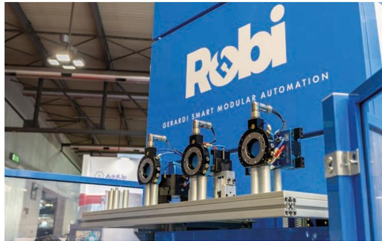
Il sistema di automazione intelligente denominato Robi di Gerardi è in grado di gestire il cambio di produzione non solo da un ciclo di lavoro a un altro ma anche dei particolari da lavorare, delle relative attrezzature e dei gripper che vengono utilizzati per cambiare le attrezzature
