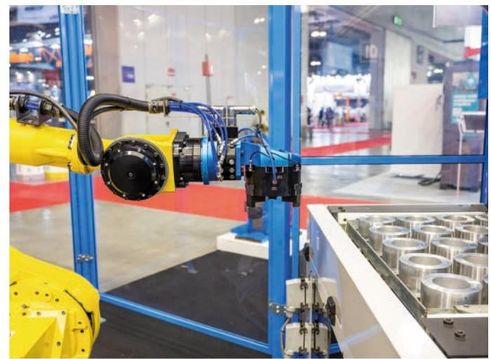
Il robot Fanuc di cui Robi è provvisto si occupa di scaricare pezzi grezzi da lavorare e attrezzature per equipaggiare da una a tre macchine utensili
