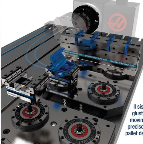
Il sistema Zeropoint è la giusta soluzione per la movimentazione e il serraggio preciso delle attrezzature sul pallet delle macchine utensili
