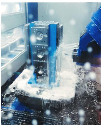
Gamma di portapezzi in fusioni monoblocco di ghisa G30 e recentemente anche in alluminio speciale ad alta resistenza.
