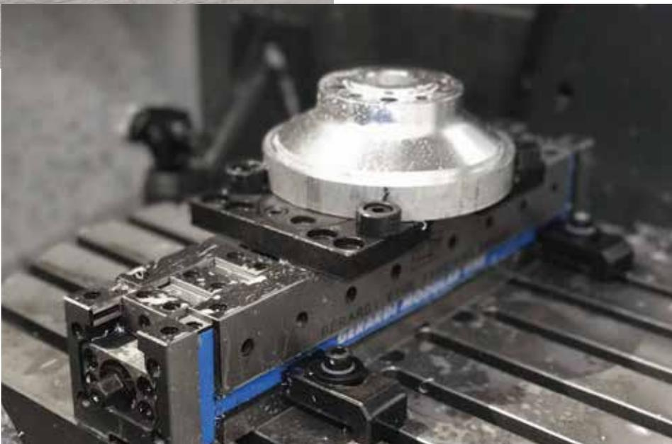
**Componente di moto in lavorazione serrato con morsa FMS Gerardi**
