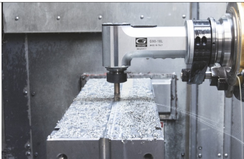
Testa angolare Classic G90-16L durante la lavorazione di un particolare.
