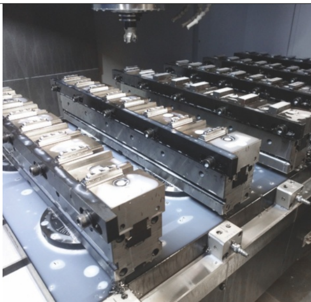
Serie di morse Multiflex montate su piastra con Zero Point, per il serraggio multiplo e la lavorazione di più particolari su centro verticale Doosan.
