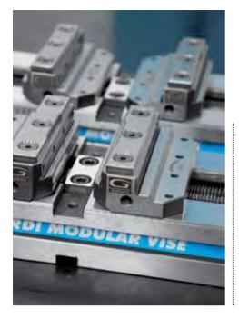
5面加工的需求与日俱增。随着性能卓越的新型 5 轴加工中心的推出,以及机床自动化机器人设备的普及,Gerardi 进一步拓展模块化夹具范围,推出两个全新系列虎钳:Multitasking(自定心、偏心、实用而便捷)和最近推出的 CompactGrip,后者也具自定心功能,但利用齿型夹紧技术和各种模块化配件,更紧凑、更实用,夹紧力更高、更有效,可根据不同零件材料,选择不同装夹方式。
