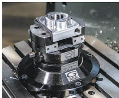
robot più diffusi e nella parte inferiore predisposta per tiranti Zero Point interamente meccanici con apertura pneumatica.
