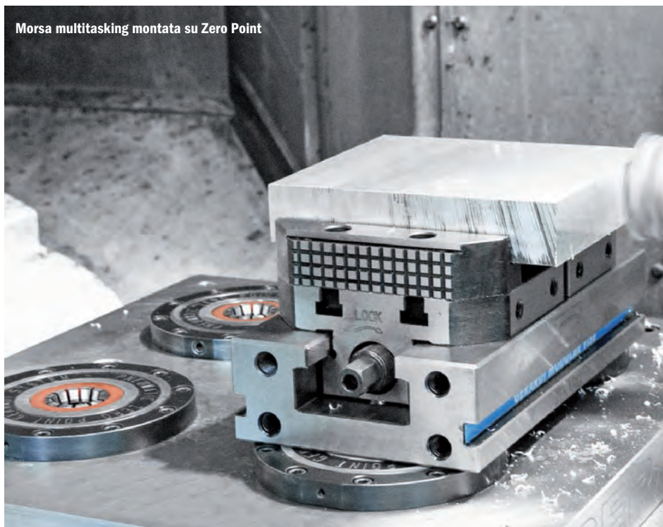
Zero Point pneumatico singolo, montaggio con flangia. Serraggio fino a 18 kN
