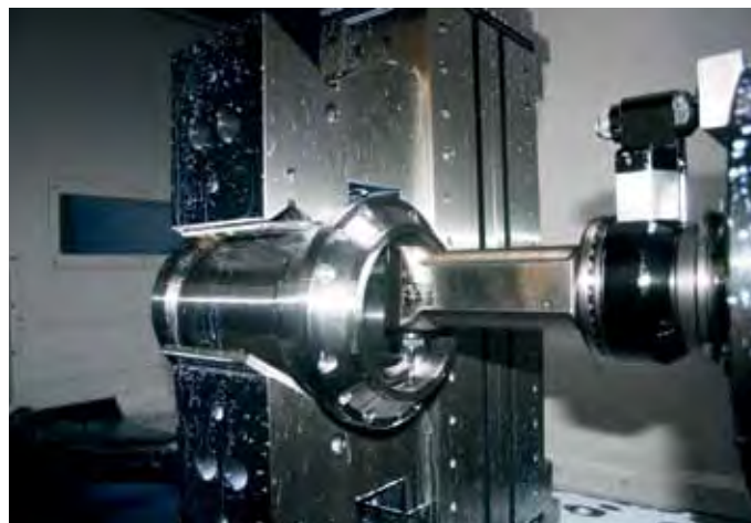
Foratura interna tramite testa angolare Gerardi Evolution Line serie ATC
